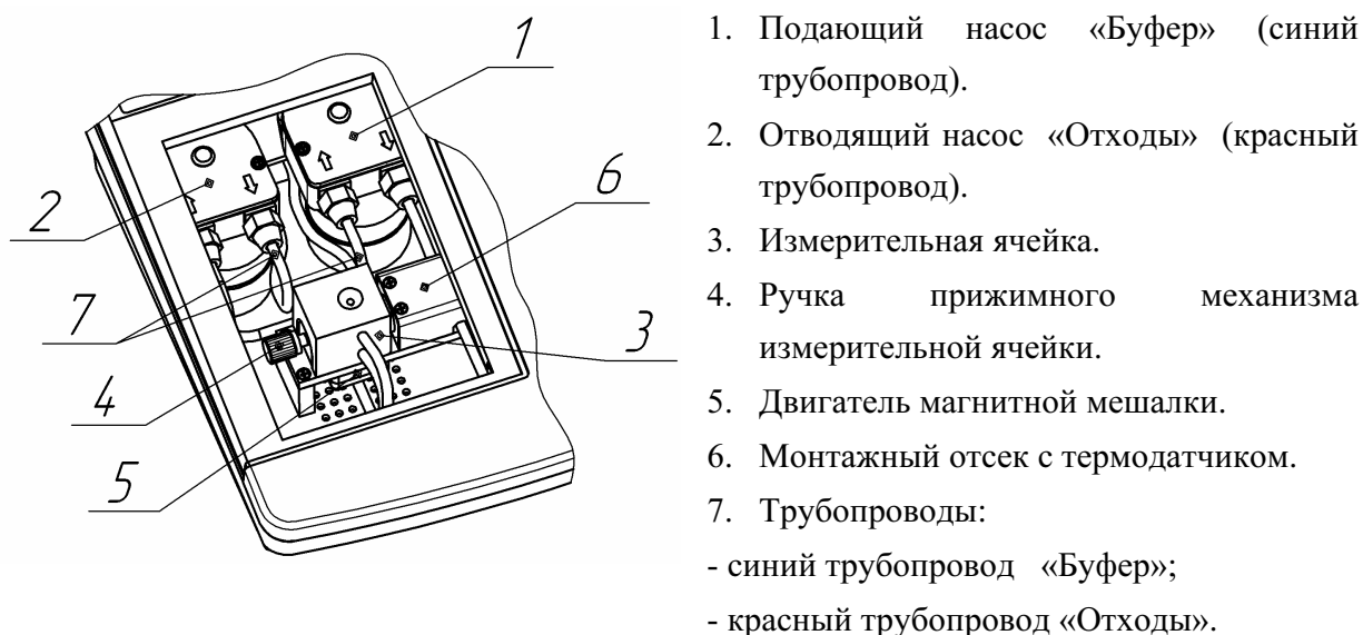
Рис.9. Вид рабочей секции анализатора (ячейка установлена).
